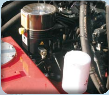
Serienmäßige automatische Zentralschmieranlage für Überwagen und Ausleger. Drucktank für das hydraulische Öl mit LufteingangsfILTER.
