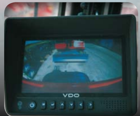
Rückfahrkamera mit 7" Farbdisplay in der Kabine (möglicher Einbau auch auf dem sekundären Ausleger)
