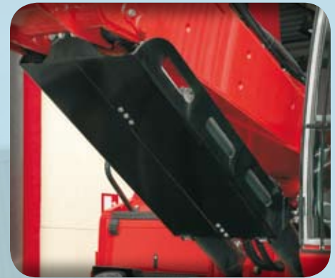
Gelenkwellesschutz für die Hubzylinder des Ausleger (auf Anfrage).
